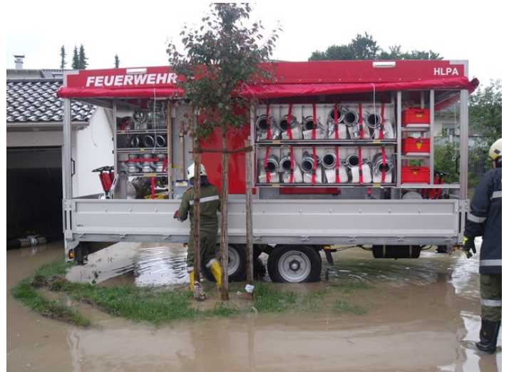
Heideweg (Bild: Hochleistungspumpe des Landesfeuerwehrverbandes Salzburg)
